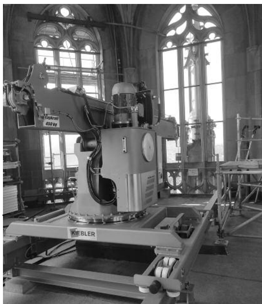
▲ Beim Aufstieg von der Viereckgalerie zur oberen Besucherplattform kann man ihn erspähen: Den vor kurzem montierte Lastenkran mit dem ausfahrbaren Teleskoparm. Der Stolz der ganzen Belegschaft der Münsterbauhütte!
