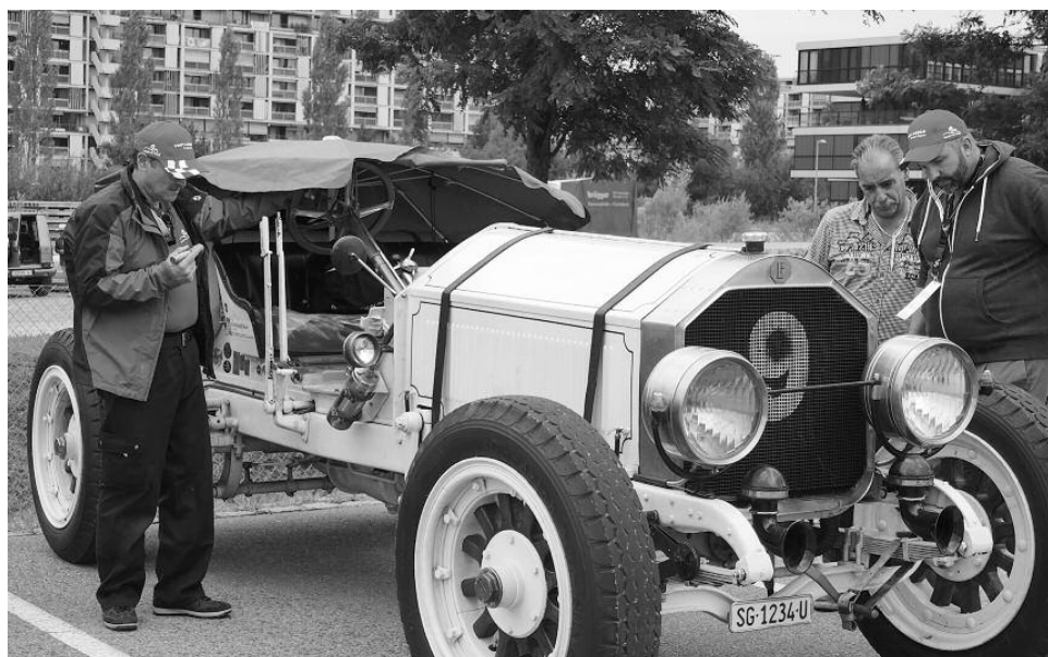
▲ Technische Kontrolle beim American LaFrance (14,5 Liter Hubraum (!), 6 Zylinder, 130 PS), der 1917 als Feuerwehrauto erstmals über amerikanische Strassen rollte.
