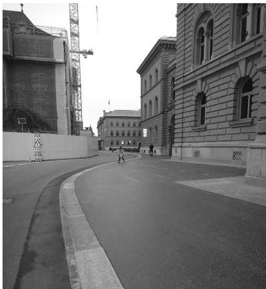
▲ Neuer Gussasphalt auf dem Trottoir vor dem Bundeshaus. Gussasphalt hat eine glänzende Oberfläche gegenüber dem maschinell eingebauten Strassenbelag, welcher einen grösseren Anteil an Split und Kies enthält und wo das Bitumen vor allen Dingen als Bindemittel wirkt.
