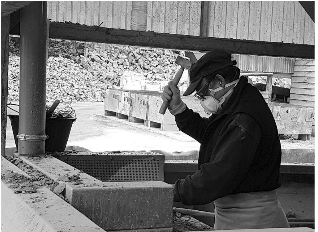
▲ Guber: Steinrichter in seiner Hütte bei anspruchsvoller Handarbeit. Die fertigen Steine landen je nach Grösse in den davor aufgereihten Mulden.
