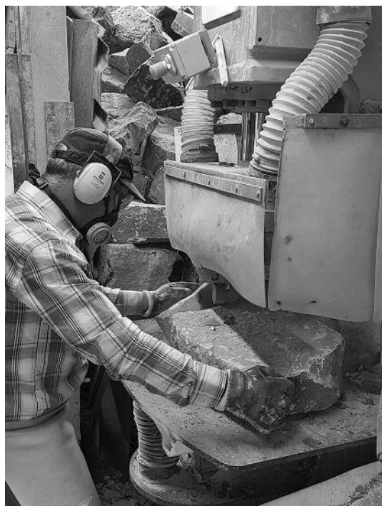
▲ Guber: Vor dem letzten Arbeitsgang werden die kleinen Blöcke gangrichtig gelegt und mit der hydraulischen Spaltmaschine zerteilt.
